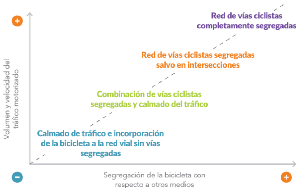
Figura 29: Segregación o integración en función de la intensidad y velocidad del tráfico motorizado
