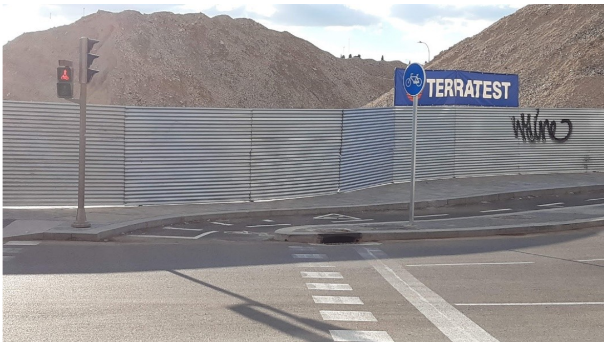
Ejemplo de giro de 90º de carril bici delimitado por bordillo. Sección escasa y tramo no iluminado
